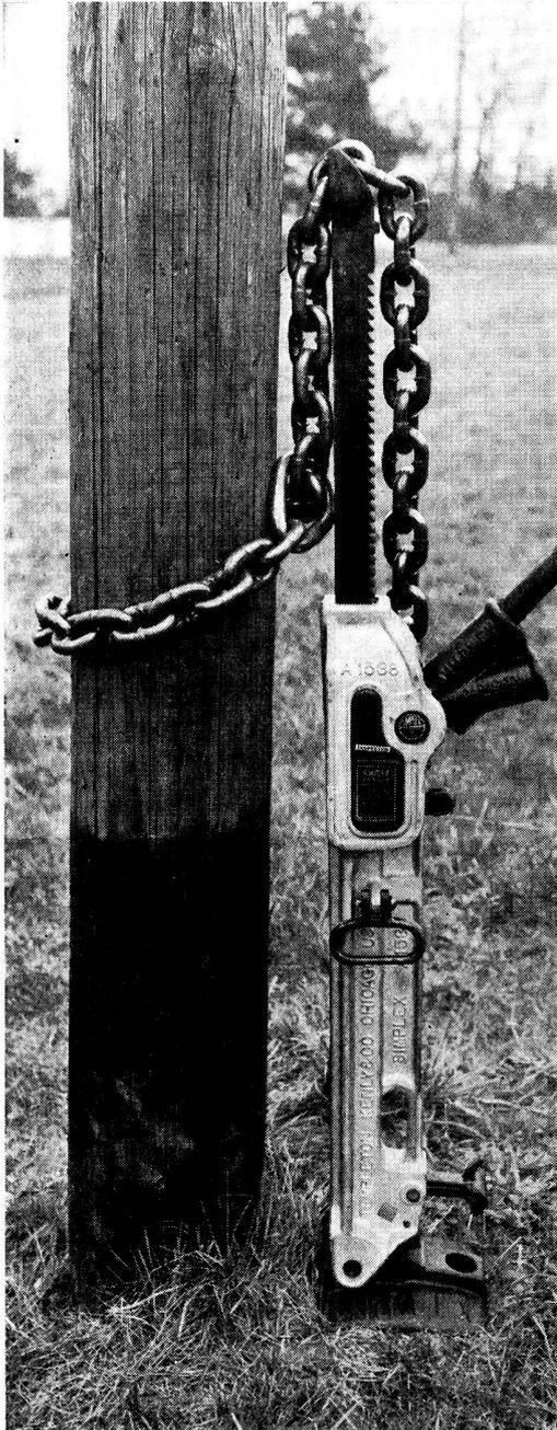
**A-1538**, die einzige Mastenwinde mit legiertem **Aluminiumgehäuse**. Wiegt nur 28 kg mit 56 cm Hub und 15 t Tragkraft, daher besonders handlich. Der Gelenkfuss passt sich den Masten und Bodenverhältnissen an. Die Winde eignet sich sowohl für Holz als auch für Betonmasten.
