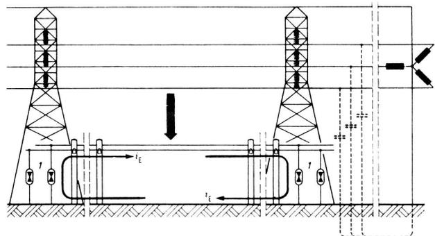
Fig. 3 Äussere Störquellen von Telefonanlagen. Induktive Störbeeinflussung durch Hochspannungsleitungen, mit Anordnung der Überspannungsableiter (1).  $i_E$  Entladestrom während einer Halbschwingung der Hochspannung (während der 2. Halbschwingung kehrt die Stromflussrichtung um). (Fortsetzung folgt)
