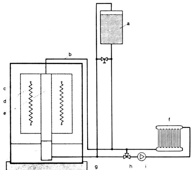
Fig. 7. Prinzip einer zentralen Blockspeicheranlage. Bezeichnungen siehe Text.
