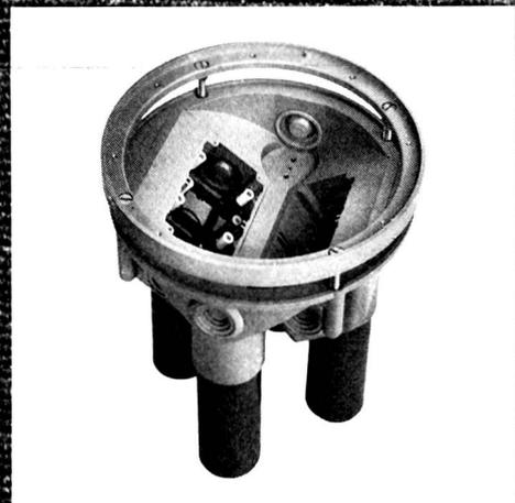
die bodenbündige Einbaudose mit Telefon- und Starkstromanschluß, fertig verlegt. Sie ist speziell für die Installation im Großraum geschaffen. Das neue Bodendoseninstallationssystem garantiert die absolute Flexibilität der Energieanschlüsse wie Telefon-, Starkstrom-, Schwachstrom- und Pneumatikanschlüsse. Verlangen Sie die ausführliche Dokumentation Bodendose zu 20.51.1
