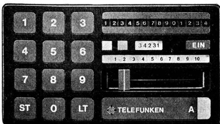
Fig. 2 Bedienplatte des Automatic-Auto-telefons S von AEG-Telefunken mit Tastenwahl und Speichermöglichkeit der anzurufenden Ortskennzahl und Teilnehmernummer. Um Fehlverbindungen zu verhindern, ist die gewählte Nummer sichtbar (oben rechts). Anrufe bei Abwesenheit des Teilnehmers werden durch eine Lampe angezeigt (unten rechts).
