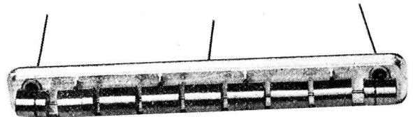
Abb. 6 Mechanisches Einseitenbandfilter Miniaturform
