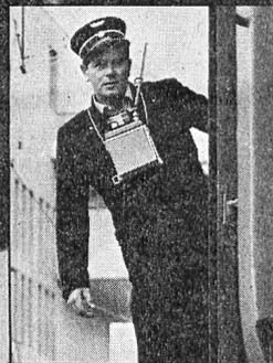
Bei öffentlichen Diensten, bei Bahnen, auf Baustellen, im Transportgewerbe, kurz: überall, wo schnelle und zuverlässige Verbindungen von Mensch zu Mensch notwendig sind, werden heute Kleinfunkgeräte eingesetzt. Das neue, volltransistorisierte, tragbare Kleinfunkgerät SE 19 von Autophon ist eine Weiterentwick-
