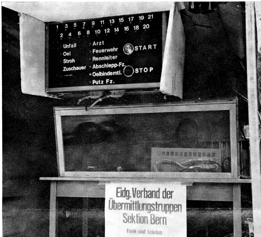
Dank einer neuartigen elektrischen Anzeigetafel am Start wird die Rennleitung und das übrige versammelte Rennkomitee innert weniger Sekunden über die Ursachen eines Startunterbruches orientiert. Konstruktion: Bruni/Herzog. (Fotos: R. Nussbaum)
