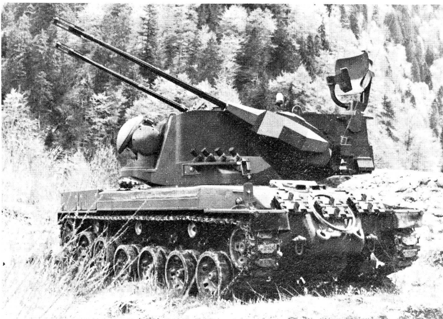
35 mm Flabpanzer Oerlikon-Contraves mit Fahrgestell des Schweizer Panzers 68
