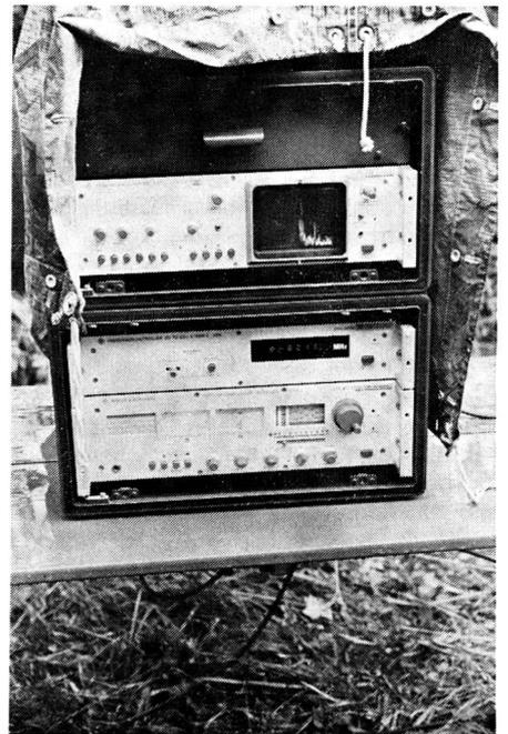
Funküberwachungsempfänger E-652 an der Felddienstübung der Sektion Thun
