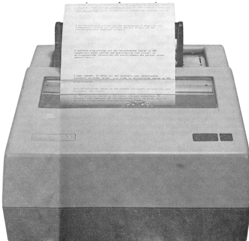
Bild 2: Der Fernschreiber HASLER SP 300 als Nurempfänger. (Aufnahmen Hasler AG)
