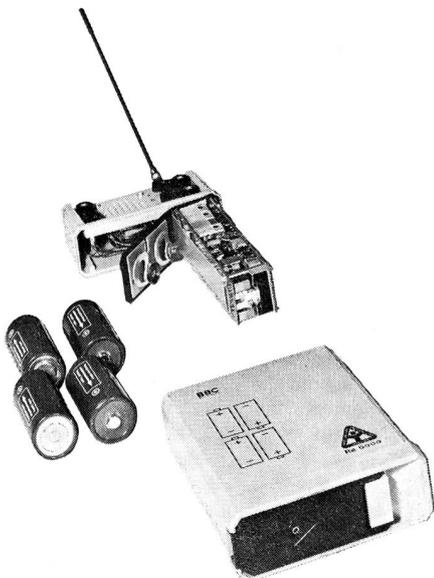
Bild 8: Innenansicht des Schutzraumempfängers
