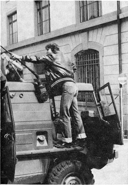
Demontage der Fahrzeugantennen, welche zur Funkstation SE-412 gehören
