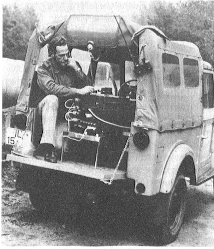
Das neueste 100-Watt-Sende- und Empfangsgerät SEG 100 D aus der DDR-Produktion, aufgebaut in einem Geländefahrzeug
