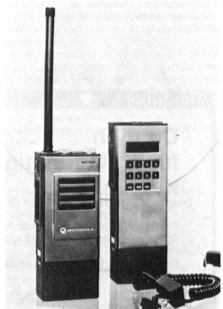
Mit einem unabhängigen Code-Programmiergerät von der Grösse eines Handfunkgerätes (rechts im Bild) wird die Eingabe des Codes in das Handfunkgerät vorgenommen.
