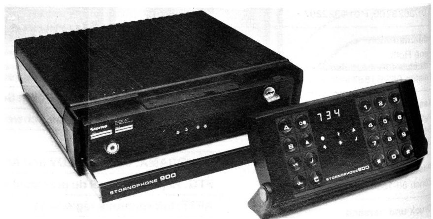
Mit dem neuen mikroprozessorgesteuerten Sprechfunkgerät CQP 900 von Storno lassen sich durch die flexible Programmierung zahlreiche Anwendungen mit den Standardversionen lösen. (Bied K+M)
