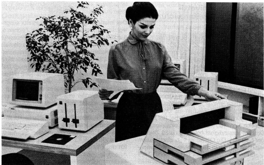
IBM-Schreib-System mit Korrekturhilfeprogramm für bis zu 50 000 Wörter. Links Arbeitsplatz mit reflexarmem Bildschirm und beweglicher Tastatur, Disketteneinheit mit zwei Laufwerken, elektronische Steuer- und Speichereinheit (unter dem Bildschirm), rechts der IBM-Typenraddrucker mit Einzelblattzuführung.
