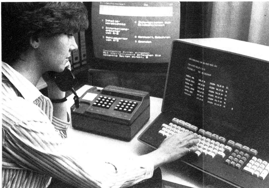
Telefongespräche, Bildschirmtext und andere Datendienste können gleichzeitig mit dem neuen digitalen Telefon über das vorhandene Fernsprechnet übertragen werden. Das jetzt von AEG-Telefunken und Telefonbau und Normalzeit an die Deutsche Bundespost zur Erprobung übergebene digitale Telefon bietet die Möglichkeit, den vorhandenen Telefonanschluss und die über 100 Millionen Kilometer Kupferleitungen in den Ortsnetzen vielseitiger zu nutzen.
