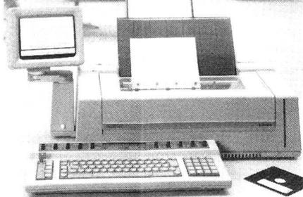
Die Textstation T 4200 von Siemens-Albis AG besteht aus dem Typenradrunder und Elektronik in einem Tischgehäuse sowie angefügtem Bildschirm und frei beweglicher Tastatur.
