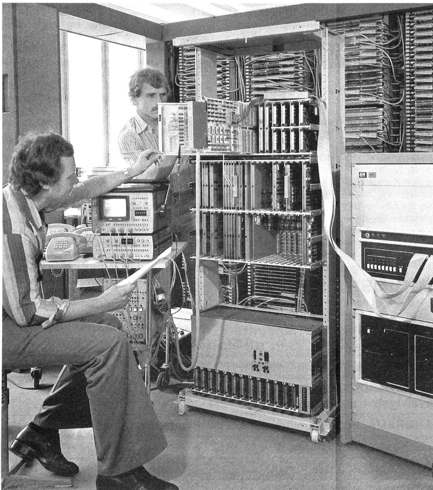
Bild 1: Bevor ein neues Kommunikationssystem der PTT zur Typenprüfung übergeben werden kann, müssen zahlreiche Entwicklungsschritte an laufend verbesserten Laboraufbauten erprobt werden. Das Bild zeigt Funktionstests an einem frühen ECS-400-Aufbau im Entwicklungslabor in Zürich-Albisrieden.
