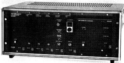
Der Messgenerator PM 5538 von Philips eignet sich für die Prüfung von Videotextdecodern und Fernsehempfängern.
