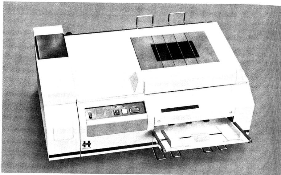
Das Fax-Chiffriersystem HC-440 setzt sich aus dem Fernkopierer- HF 2060 und dem Chiffriergerät CRYPTO FAX (links aussen) zusammen.
