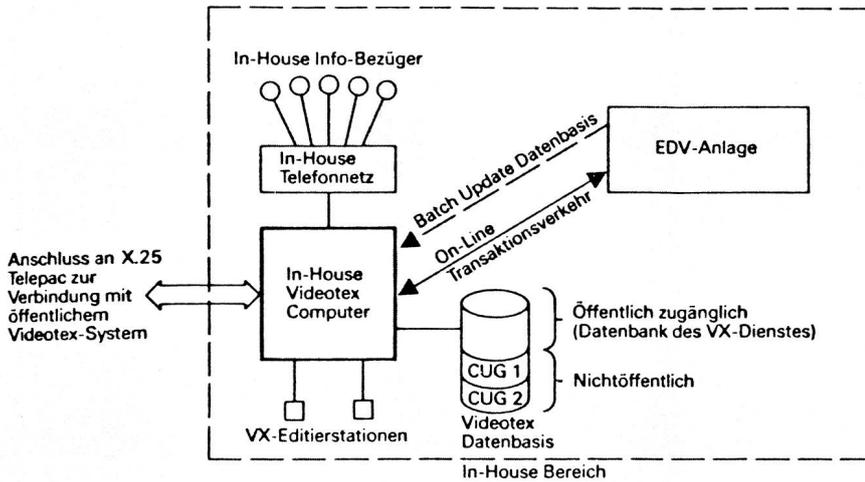
In-House-Videotex-Systeme können sowohl ausschliesslich im eigenen Bereich eingesetzt als auch mit öffentlich zugänglichen Systemen kombiniert werden.
