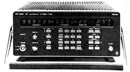
Philips PM 5390: HF-Synthesizer mit vielseitigen Modulations- und Sweeppmöglichkeiten
