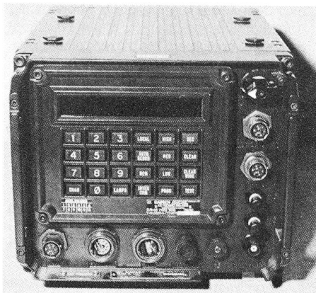
Abbildung 1 Sender-/Empfänger-Kombination mit Tastatur für Eingabe, Displayzeile, Anschluss- und Bedienungselementen
