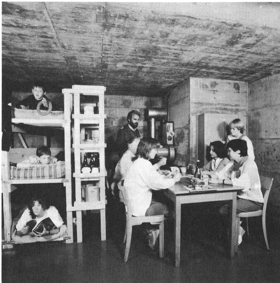
Die Schutzraumbewohner werden vom Schutzraumchef oder einer Schutzraumchefin betreut. Je Person steht 1 Quadratmeter Platz oder 2,5 Kubikmeter Raum zur Verfügung.
