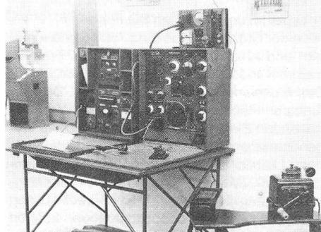
Tragbare schwere Funkstation TS 25: links Tragbarer Empfänger E 25 (Tfk Spez 7 Bs), Mitte Sender Tfk AR 245, rechts Handdrehgenerator HDG 1.
