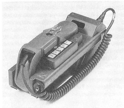
Die Bedieneinheit besteht aus dem Gehäuse-oberteil (Tastatur, Anzeige und Ruforgan) sowie dem Gehäuseunterteil (Elektronik und NEMP-Schutz). Das Gehäuse ist feldtauglich, verfügt über einen von aussen zugänglichen Batteriekanal (vier «Mignon»-Batterien) und ist auf der Rückseite mit einer Kurzbedienungsanleitung versehen.
