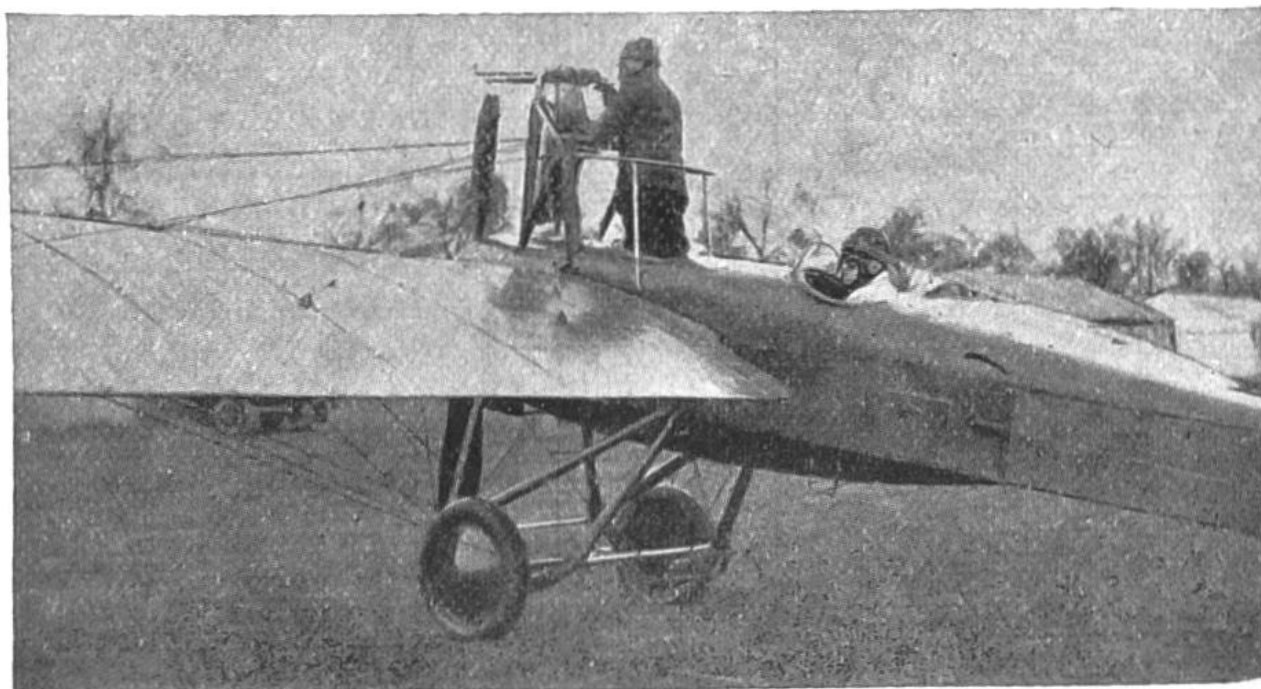
Französischer Flugapparat mit Maschinengewehr zum Auffliegen bereit; der Führer sitzt hinten; der Schütze steht vorn auf einer befestigten Plattform.
