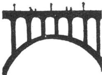
1870. Betoneisenbau von Monier in Paris erfunden, verbessert von dem belgischen Steinhauer Hennebique. Durch Einlegen von dünnen Eisenstäben werden Zement-Balken und -Säulen zehnfach verstärkt. Sehr wichtig für Haus- und Brückenbau.
