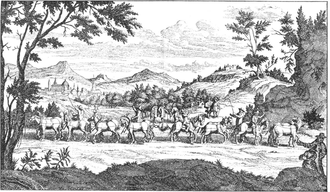
Ein berühmtes Experiment zum Nachweis des Luftdruckes: Otto von Guericke führt anno 1654 Mitgliedern des Reichstags zu Regensburg seine „Magdeburger Halbtugeln“ vor. 16–24 Pferde vermochten die dicht aufeinander gepaßten, luftleeren Halbtugeln nicht auseinander zu reißen. Als Luft einströmte, fielen sie auseinander.
