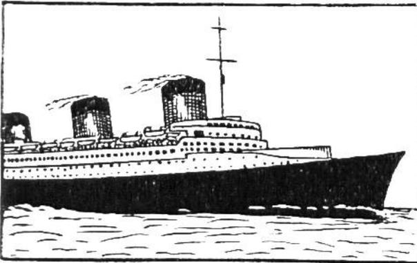
1937 fuhr die „**Normandie**“ die vorgeschriebene Strecke in 3 Tagen, 22 Std., 7 Min. Sie besitzt das ‚Blaue Band‘. Das 313 m lange Riesenschiff ist mit Elektro-Turbinen ausgerüstet und vermag 3050 Personen aufzunehmen.
