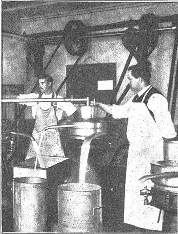
Das Zentrifugieren der Milch. Die frische Milch fliesst in eine Stahltrommel, die sich in der Minute 6500mal dreht, und wird dabei in Rahm und Magermilch getrennt.
