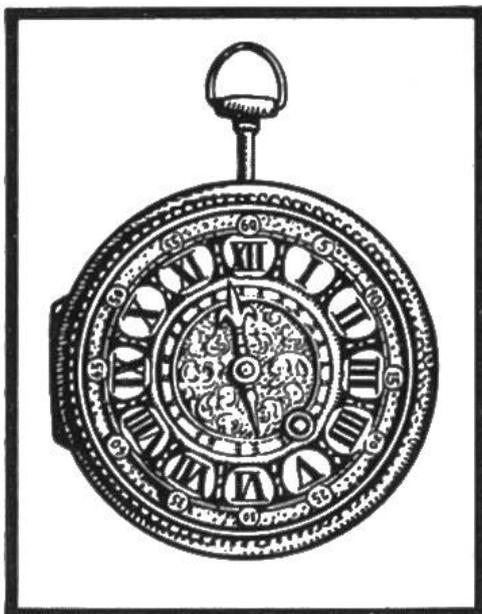
**Spiralfeder-Uhr.** Bisher wurde in den Taschenuhren als Regulator die nur ungenau arbeitende Waage verwendet, da man das Pendel hier ja nicht benutzen konnte. Nach der Erfindung der Spiralfedern mit Schwungrad übernahmen diese die Arbeit der Waage. Einer der ersten, der eine so verbesserte Uhr baute, war Daniel Jeanrichard aus La Sagne (Neuenburg). Er gilt als Begründer der Schweizer Uhrenindustrie.
