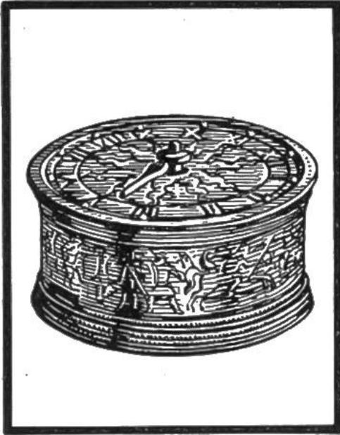
**Tischuhren mit Räderwerk** gab es zu Ende des 15. Jahrh. Sie bestanden meist aus einem bronzenen Gehäuse, welches das ganz aus Eisen gefertigte Werk umschloss. Da das Zuggewicht der grossen, senkrecht stehenden Räderuhren bei flach liegenden Tischuhren nicht verwendet werden konnte, benutzte man spiralförmig gewundene Federn, welche das Werk vermöge ihrer Spannkraft in Gang hielten.
