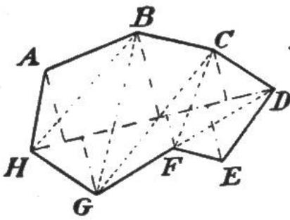
Die Fläche kann berechnet werden durch Zerlegung des Vielecks in Dreiecke mittels Diagonalen u. Summierung der ermittelten Dreiecksflächen, oder auch durch Einteilung in Trapeze u. Dreiecke vermittleis einer passend gewählten Abszisse und rechtwinklig auf diese errichteten Koordinaten der Eckpunkte, Summierung des ermittelten Inhalts dieser Trapeze u. Dreiecke.
