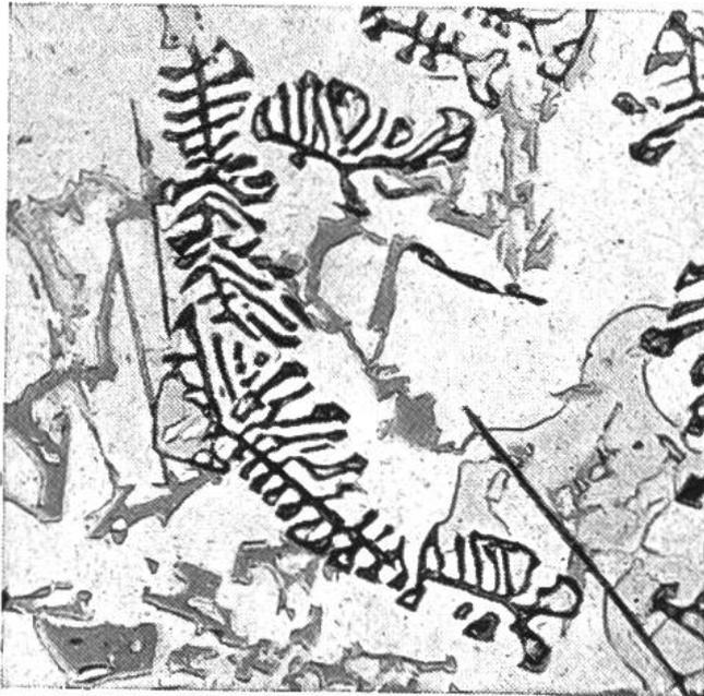
**Leichtmetallguss.** Nicht minder interessant ist das Auftreten der sog. Chinesenschrift in einem aus Aluminium-Silizium-Eisen-Kupfer bestehenden Leichtmetallguss von bestimmter Zusammensetzung. (Foto: ein Stück Automobil-Steuergehäuse.) Aus den Kristallformen kann auf die chemische Zusammensetzung geschlossen werden. (250-fache Vergrößerung.)
