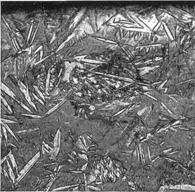
**Randzone eines falsch gehärteten Zahnrades.** Die Beschaffenheit dieses Feingefüges deutet auf Härtung aus zu hoher Temperatur hin. Die hellgrauen Nadeln sind Martensit, die dunkleren, grossen, breiten Kristalle Austenit. Das richtige Gefüge sollte demjenigen des gehärteten Schienenstahls gleich sein. (200-fache Vergrößerung.)
