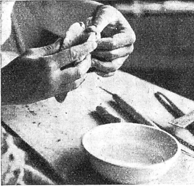
Das Anfertigen des Henkels.
