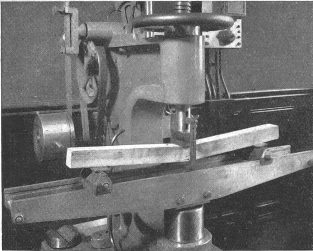
Abb. 3. Prüfung eines 60 cm langen Holzstabes auf Biegung.
