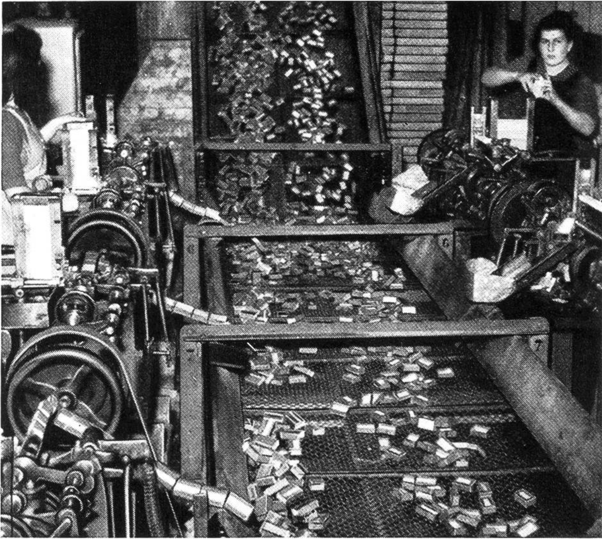
Auf dem laufenden Band passieren die überklebten Innen- und Aussenschachteln den Trocknungskanal.
