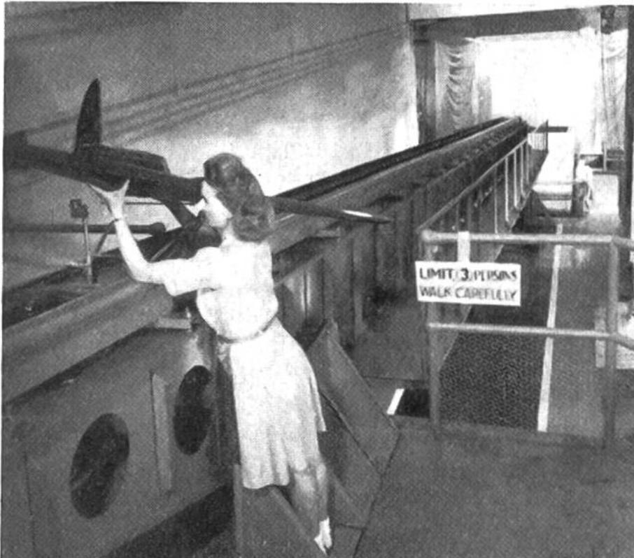
Eine Schleuderbahn, von der aus Flugzeugmodelle auf einen Wassertank geschleudert werden können.
