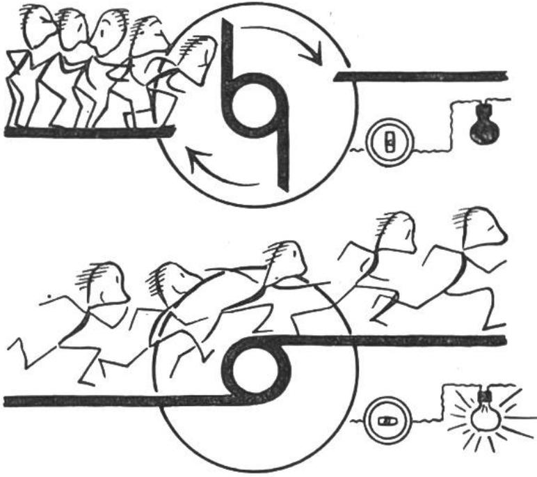
Die nebenstehende Zeichnung erklärt auf lustige Weise das Funktionieren eines Lichtschalters. Ist er abgedreht, staut sich der Strom vor der Kluft, die er nicht meistern kann. Aber eine Vierteldrehung genügt – und die Brücke ist hergestellt: die Lampe kann hell erstrahlen!
