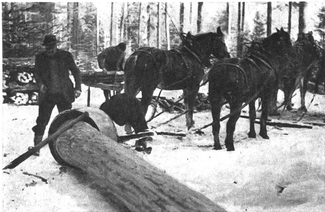
Holzschleifen mit einer Schlepphaube, die das Beschädigen der Wurzelstöcke stehengebliebener Bäume durch den Stamm verhindert.
