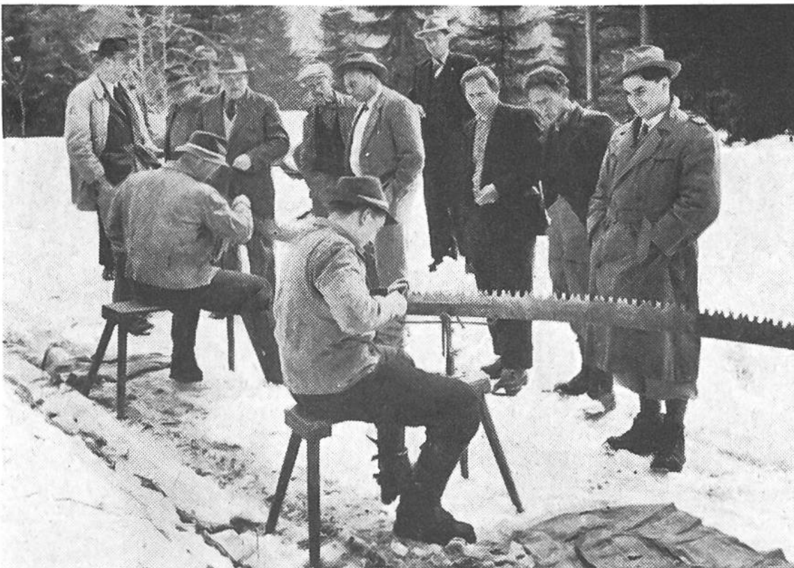
Feilen von Hobelzahnsägen an einem Werkzeugkurs für Waldarbeiter.
