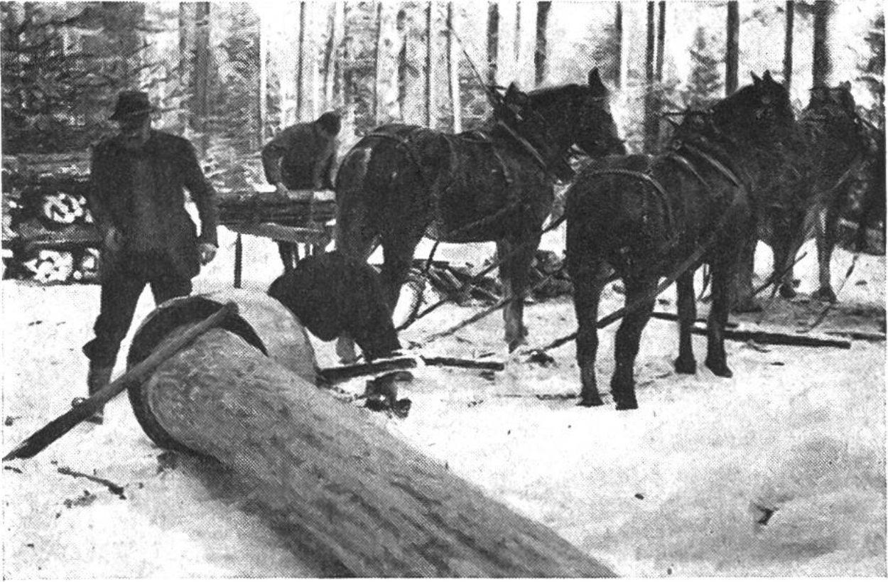
Holzschleifen mit einer Schlepphaube, die das Beschädigen der Wurzelstöcke stehengebliebener Bäume durch den Stamm verhindert.
