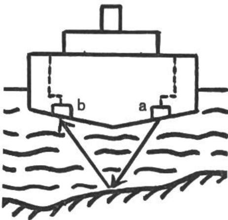
Eine Welle dreht sich mit konstanter Geschwindigkeit, wobei regelmäßig ein Kontakt geschlossen wird. Ein Sender a im Schiffsboden schickt nun Impulse (hörbare Töne oder Ultraschall) aus, die bei einer Geschwindigkeit von ca. 1500 m/sek. nach wenigen Sekunden vom Meeresboden reflektiert zum Empfänger b zurückkehren und eine Neonröhre, die sich inzwischen mit der
