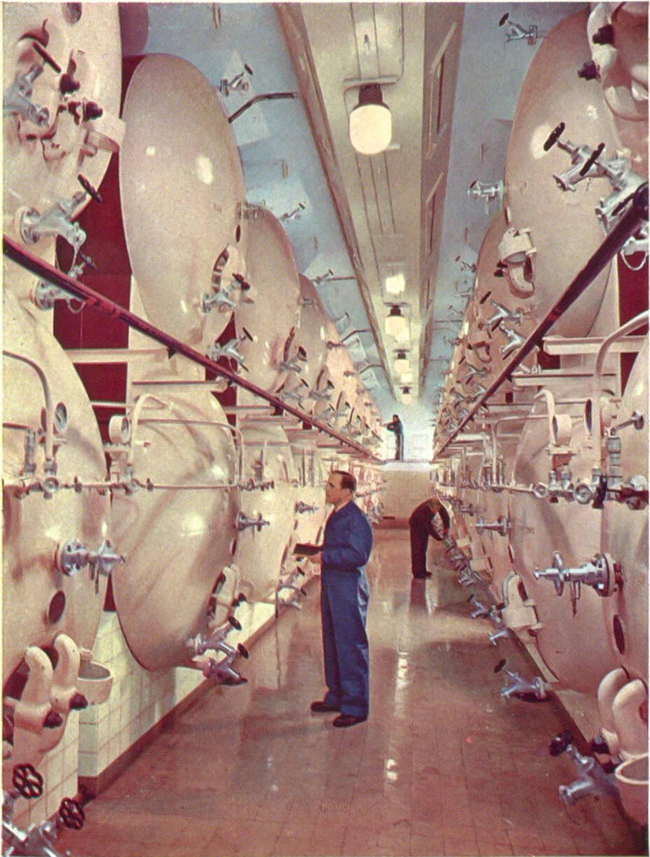
1 000 000 Liter Süßmost lagern in diesen Stahltanks! Bei 0° C und 3,5 Atmosphären Kohlendruck ist die Haltbarkeit garantiert.
