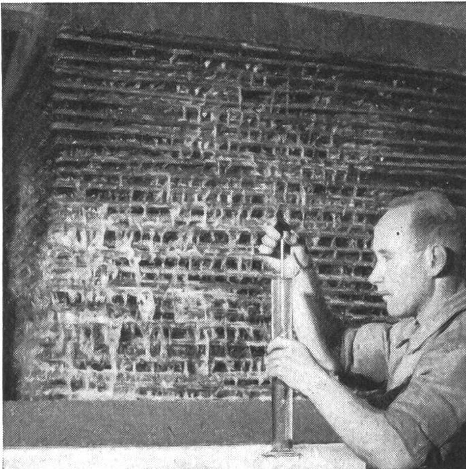
Köstliche Ströme von Obstsaft fließen! Aus den zu Mus vermahlenden und zwischen feste Tücher gepackten Früchten wird mittels der hydraulischen Presse der Saft gewonnen. Der Moster kontrolliert mit Hilfe der Oechslewaage den Zuckergehalt des Saftes. (Photo Ernst Brunner, Luzern).
