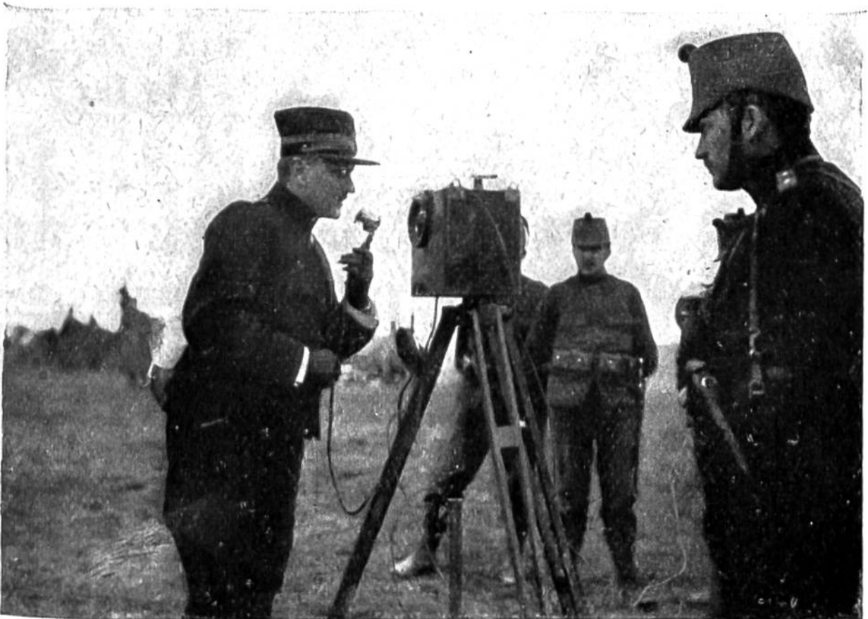
Die telephonische Verbindung mit dem aufgestiegenen Fesselballon.
