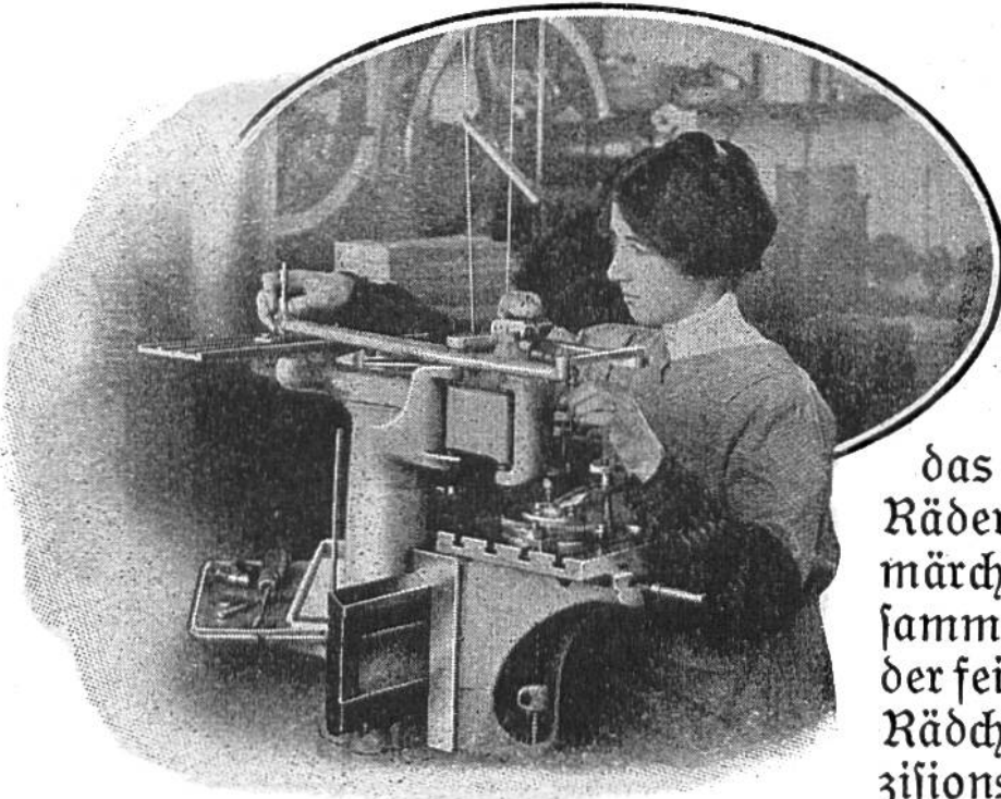
Maschinen-Gravieren in Uhrwerken. Zenith.
