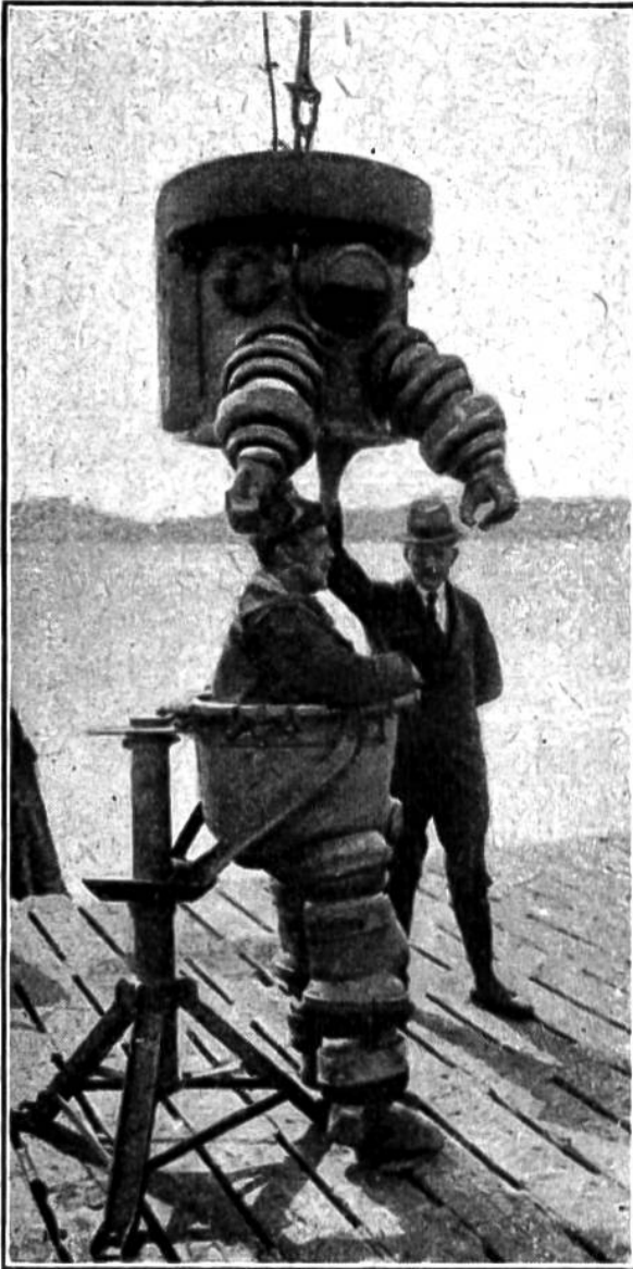
Eiserne Hosenträger. Die schwere Glode mit den Greifhänden wird heruntergelassen und aufgeschraubt.
