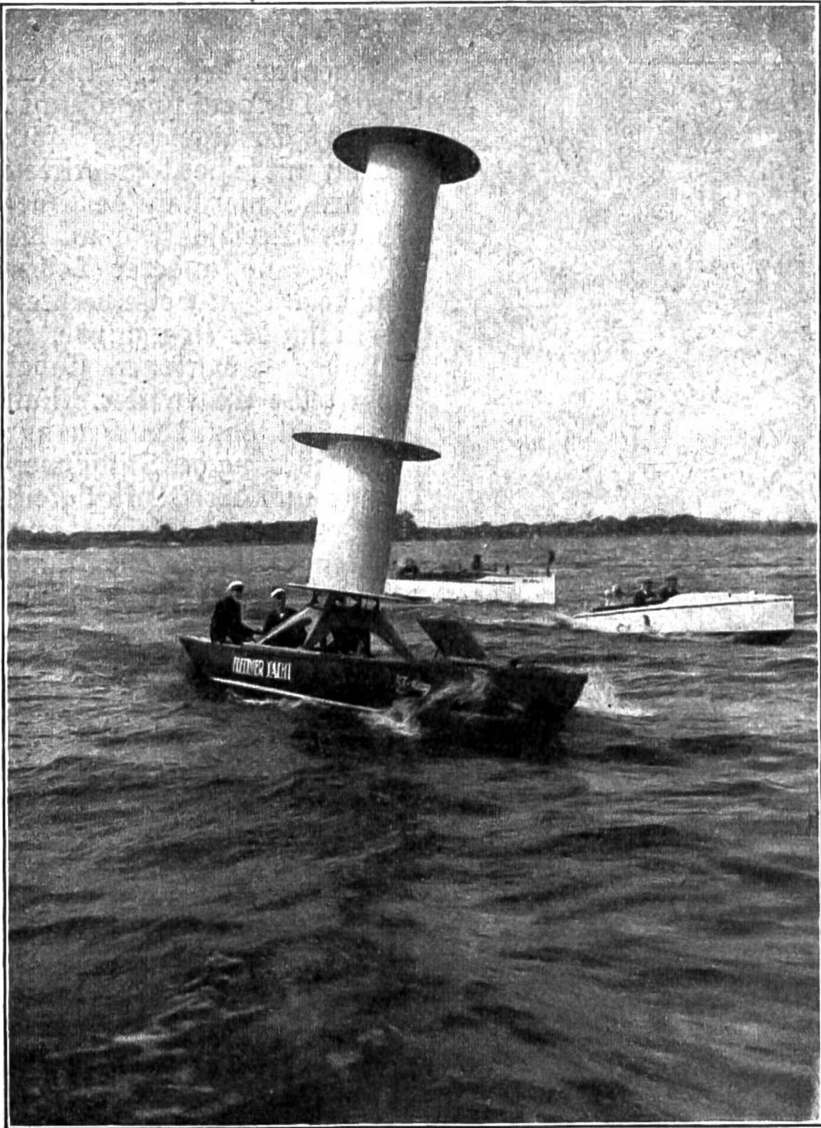
**Flettner „Rotor-Yacht“, das neue Segelschiff ohne Segel in voller Fahrt. Die Leinwandflächen sind durch sich drehende Blechzylinder ersetzt. Das Schiff hat sich bei Versuchsfahrten vorzüglich bewährt.**
